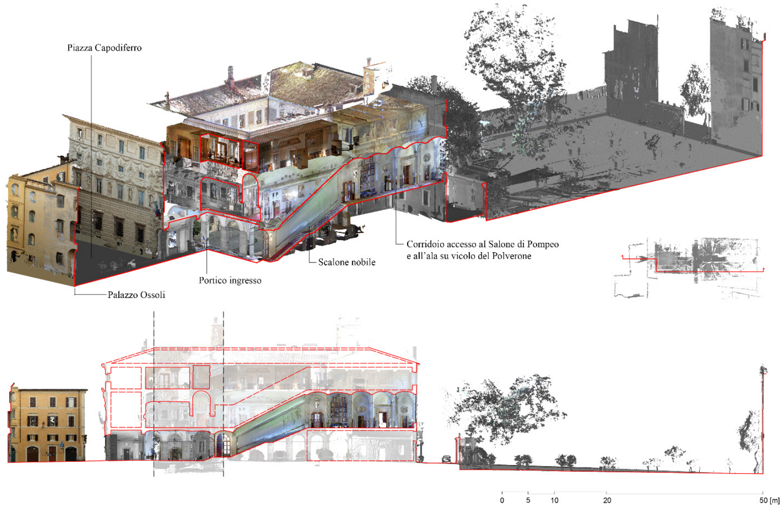
Fig. 12: Sezione assonometrica della nuvola di punti: in evidenza il percorso dalla piazza al salone e sviluppo in piano del percorso (elaborati degli autori).
