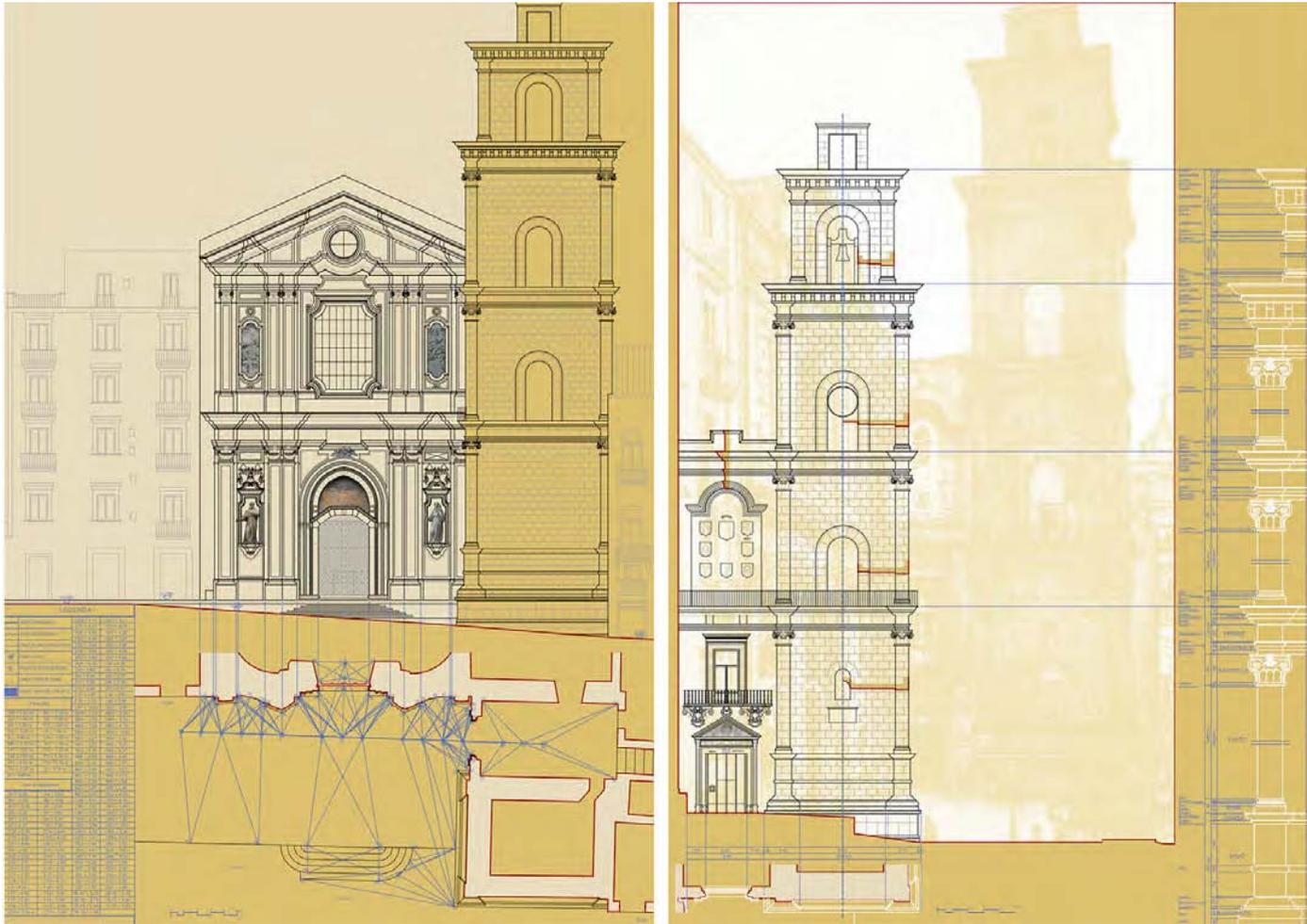
Figg. 24, 25: Elaborati grafici di rilievo relazionati ai dati dedotti dalla restituzione fotogrammetrica per il complesso di San Lorenzo. Disegni di Daniela Palomba.
