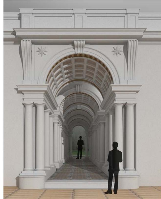
Fig. 6: A sinistra, galleria prospettica di palazzo Spada di Francesco Borromini. Elaborati grafici di rilievo a seguito di acquisizione digitale scanner laser (elaborati a cura dell'autore).
