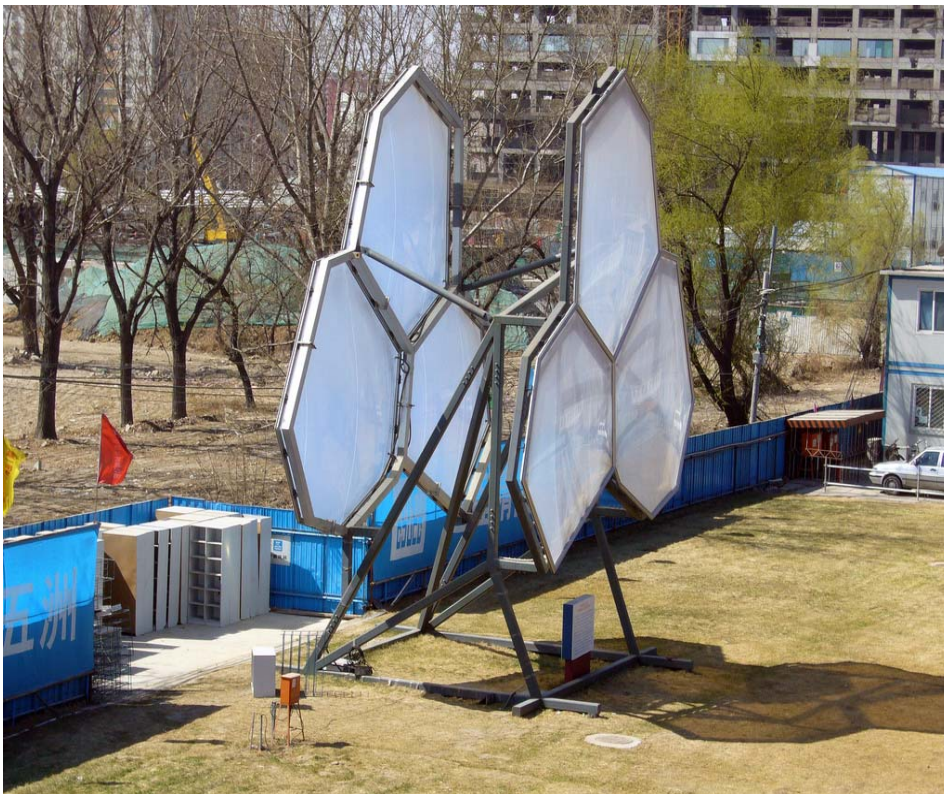
La fase di sperimentazione delle membrane utilizzate per la superficie delle bolle del water cube.
