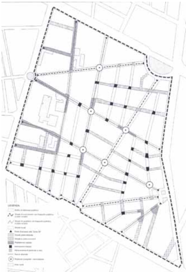
Linee guida zone 30 della Regione Piemonte. Schema complessivo di un ambito residenziale in cui va realizzata una zona 30: planimetria e legenda.
