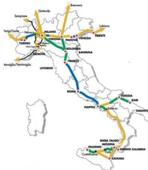
La rete ferroviaria dell'Alta Velocità in Italia: linee in esercizio (blu), linee in costruzione (verde) e linee in progettazione (giallo).
