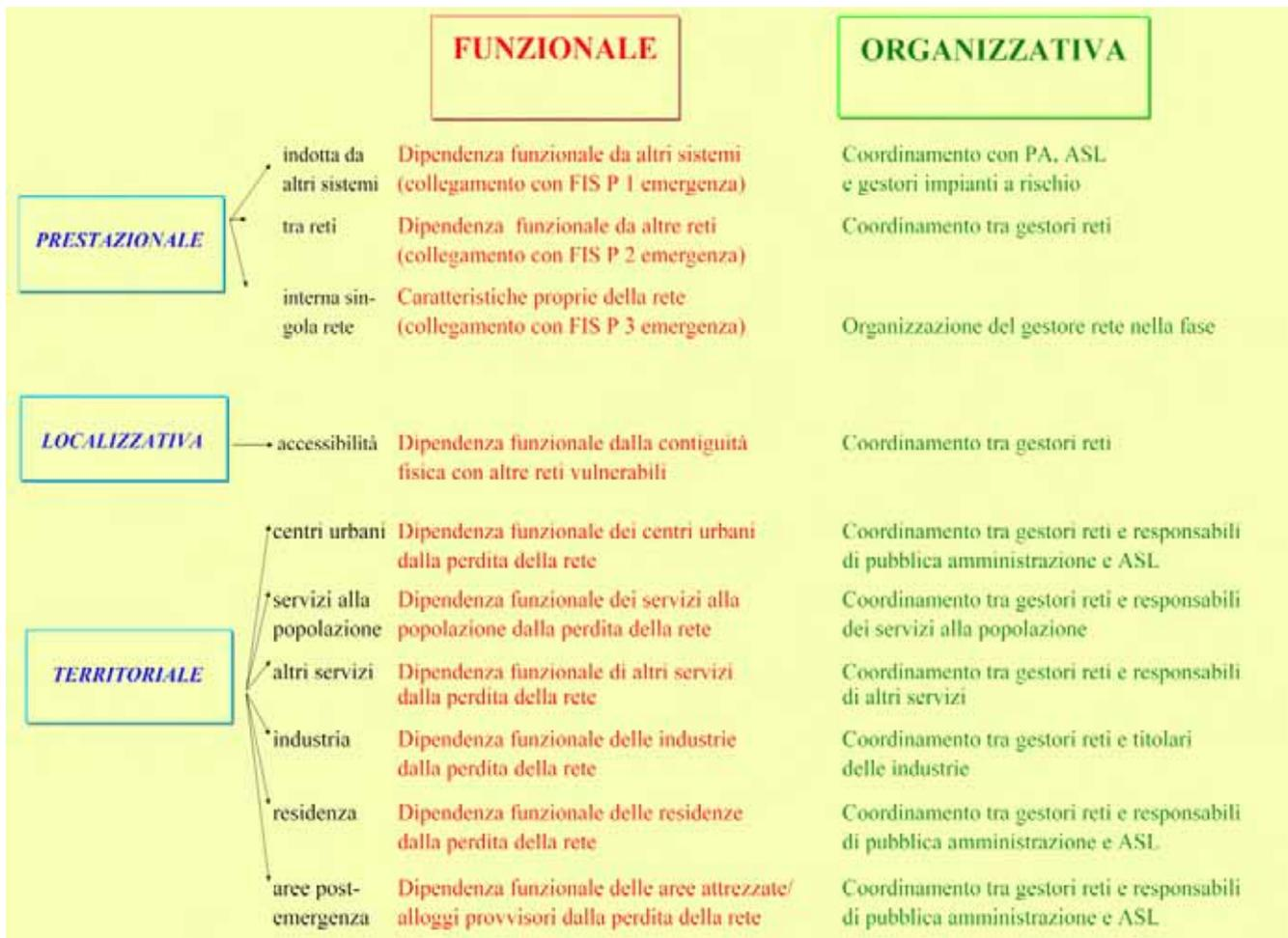
Schema per la valutazione della vulnerabilità nella fase di ripristino/ricostruzione.
