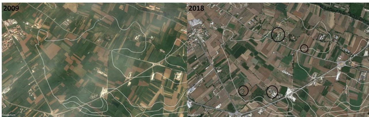
Figura 5: Confronto tra due immagini satellitari per un'area a elevata pericolosità idraulica nel comune dell'Aquila. In nero sono evidenziati alcuni degli interventi edilizi effettuati successivamente al sisma del 2009. Fonte: elaborazione dell'autore su immagini tratte da Google Earth
